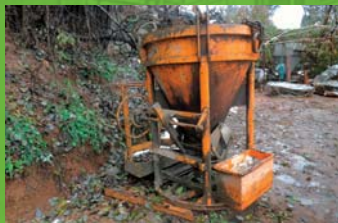
бункеры для бетона
