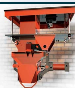
Весовой гравитационный дозатор для фасовки в открытые мешки
