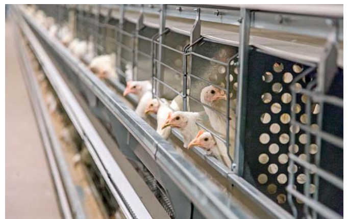
Для ЗАО «Птицефабрика Чайковская» переданы в лизинг два комплекса клеточного птицеводческого оборудования на 180 тысяч птицемест для кур-несушек немецкой компании «Hellmann Poultry GmbH & Co. Kg» с системой кормления кормораздаточными бункерами, с продольными пп-лентами для помёта и сбора яиц, с узлом подачи воды.
